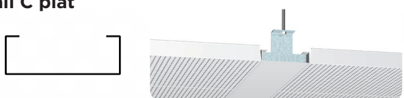
Porteur aluminium joint creux GAUGUIN pour barrière phonique
